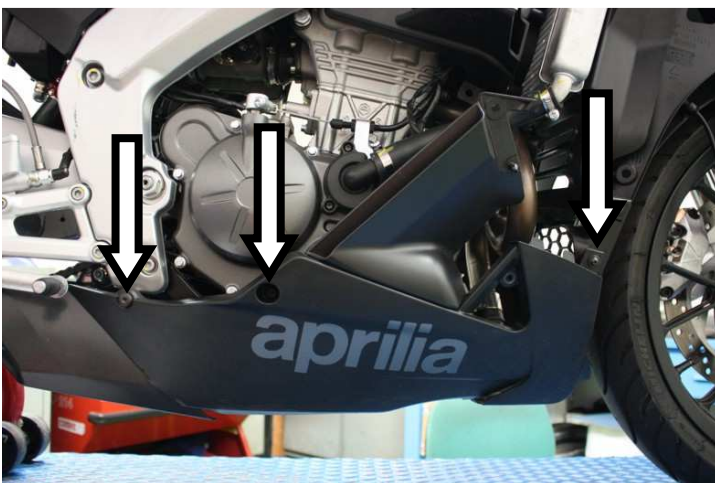
Svitare le viti (3) e rimuovere la carena inferiore DX Remove the screws shown above and remove the lowe RH bodywork
