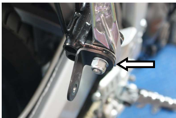
Avvitare al perno la staffa di sostegno terminale Fit the mounting bracket as shown above
