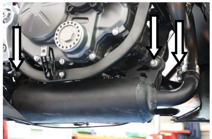
Allentare la fascetta, svitare le viti (2) e rimuovere lo scarico originale Loosen the hose clip, remove the screws shown above and remove OE exhaust system
