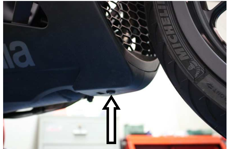
Rimuovere la clip posta sotto il puntalino Remove the pin shown above, on the bellypan
