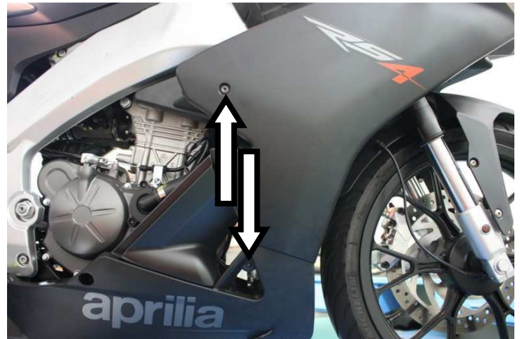
Svitare le viti (2) e rimuovere la carena superiore DX Unscrew the screws shown above and remove the upper RH bodywork
