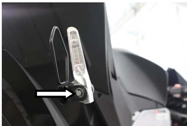
Rimuovere il fermo e sfilare il perno dal pedalino passeggero DX (attenzione alla molla ed alla sfera) Remove the pin from the passenger's RH footrest
