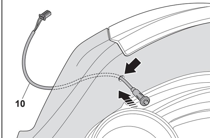
**GR** Αφαιρέστε την τάπα **N** της φίσας **M** του οχήματος και φυλάξτε την προσεκτικά, στη συνέχεια συνδέστε την καλωδίωση **9** του κιτ στο όχημα, όπως υποδεικνύεται στην εικόνα: συνδέστε τη φίσα **9a** στη φίσα **M** του οχήματος και τη φίσα **9b** στον εγκέφαλο του αντικλεπτικού **1**.
