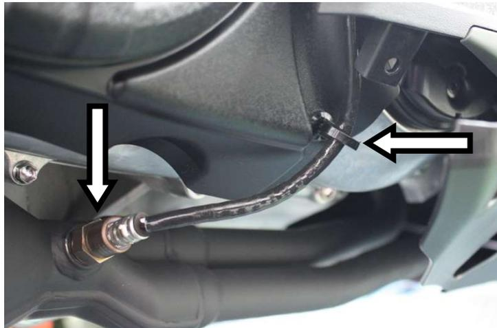
**IT** · Tagliare la fascetta di fissaggio del cavo e svitare la sonda lambda
