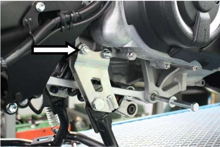
**IT** · Sostituire la vite con quella fornita e serrare la staffa mediante dado originale
