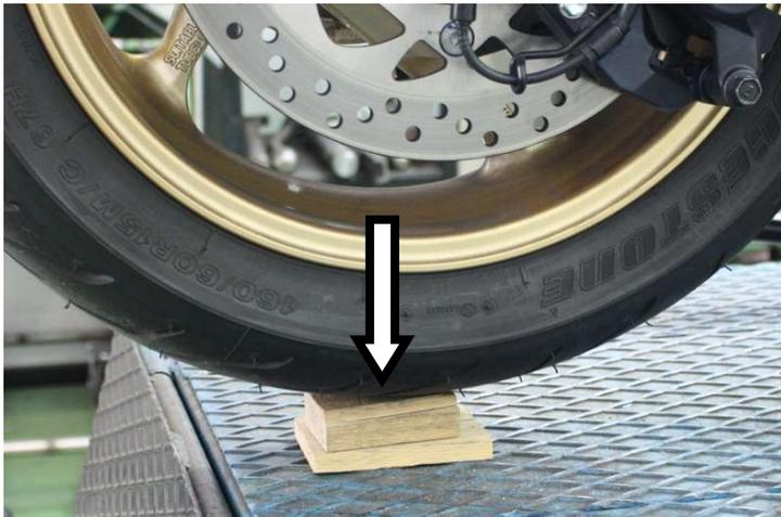
**IT** · Posizionare uno spessore sotto la ruota posteriore per tenerla in posizione
