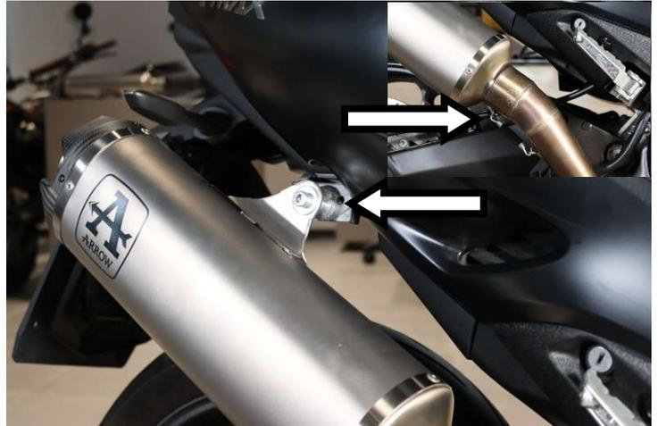
**IT** · Serrare il terminale mediante fascetta interponendo col telaio lo spessore fornito ed ancorare la molla
