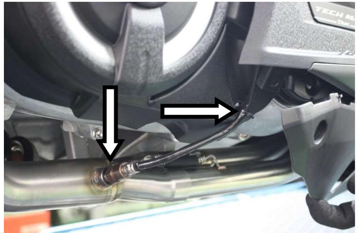
**IT** · Avvitare la sonda lambda e fissare il cavo mediante fascetta fornita
