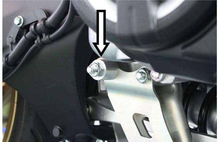
**IT** · Serrare la staffa del cavalletto utilizzando lo spessore fornito (solo nel caso in cui non si voglia sostituire la vite indicata con la M10x50 fornita nel kit di montaggio – passare a pagina 4)
