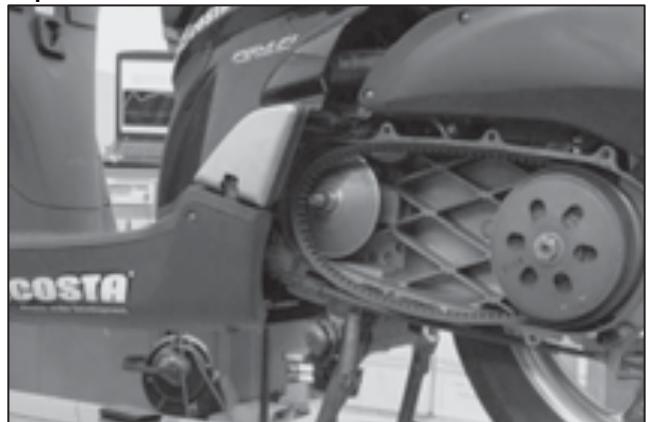
Desmontamos la polea fija
