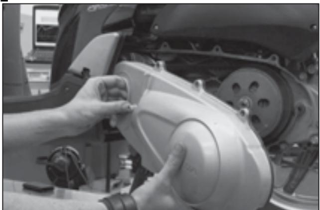
Antes del montaje del variador debemos retirar la tapa que cubre el sistema de transmisión automática.
