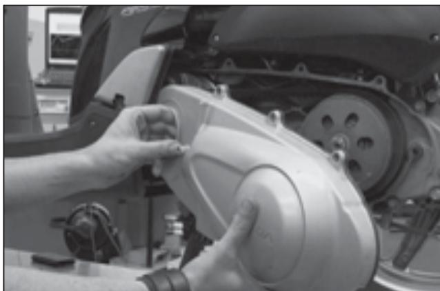
Avant le montage du variateur, il faut retirer le couvercle qui couvre le système de transmission automatique.
