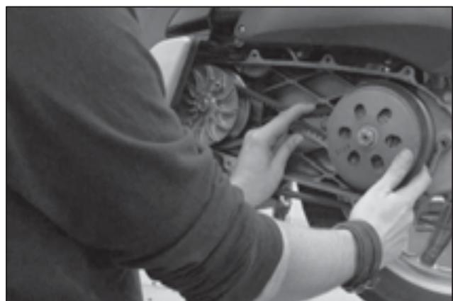
Avant de serrer la femelle, contrôler que la courroie reste détendue.
