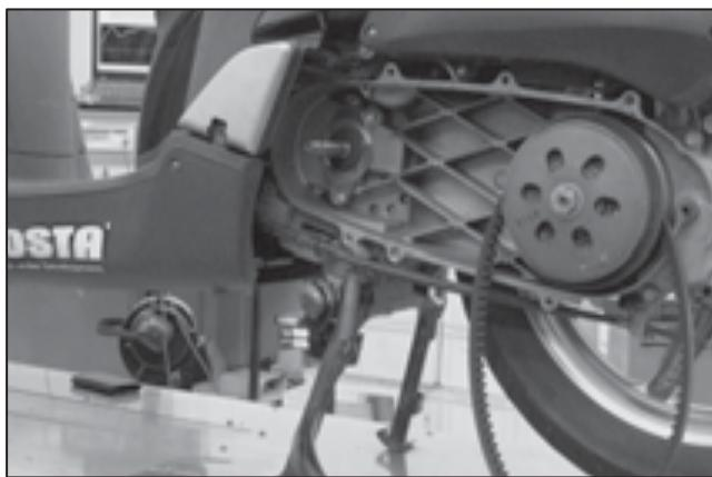
Retiramos el variador que lleve montado. Una vez retirado procedemos a limpiar todos los residuos de grasa, aceite y polvo de la transmisión primaria, cuello del cigüeñal y bulón. El bulón se lubrica con las inserciones de grafito que lleva el casquillo central del variador J. COSTA. Si no se elimina la grasa, esta junto con el grafito generará una pasta que puede bloquear el movimiento del bulón sobre el casquillo (gripado). Si esto ocurre limpiarlo todo bien con un solvente y volver a montar.
