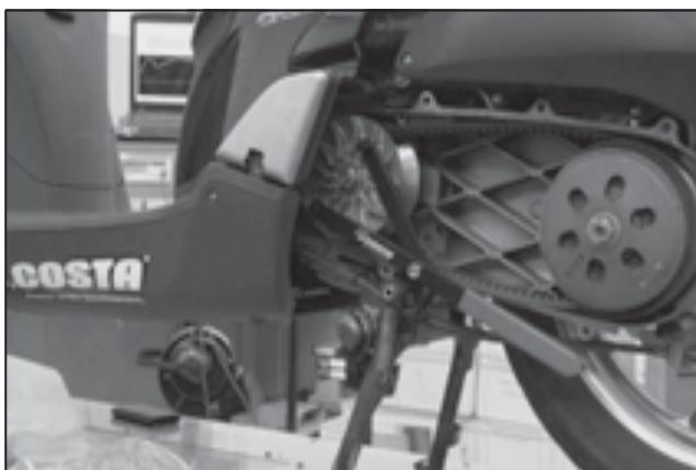
Antes de apretar la tuerca colocar el útil para el bloqueo de la polea fija.
