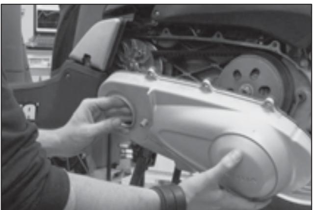
Volver a colocar la tapa que cubre y protege el sistema de transmisión automática. El variador ya está listo para ser utilizado.
