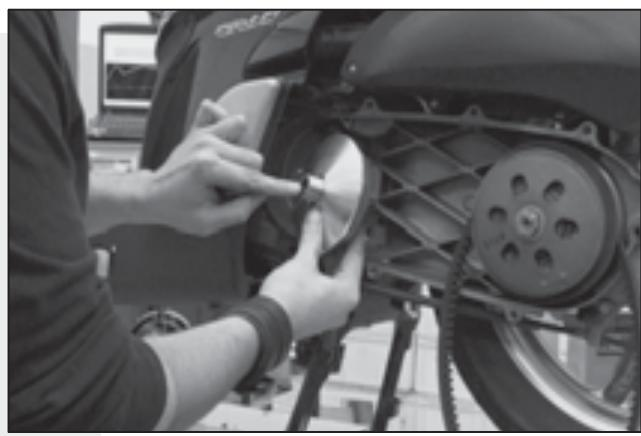
Placer le variateur sur le col du vilebrequin. Respecter toujours la position des possibles rondelles du variateur d'origine. J.Costa conseille de substituer la courroie existante par une nouvelle courroie J.Costa renforcée, lors du changement du variateur.
