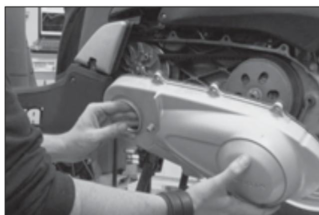
Replacer le couvercle qui couvre et protège le système de transmission automatique. Le variateur est prêt à être utilisé.
