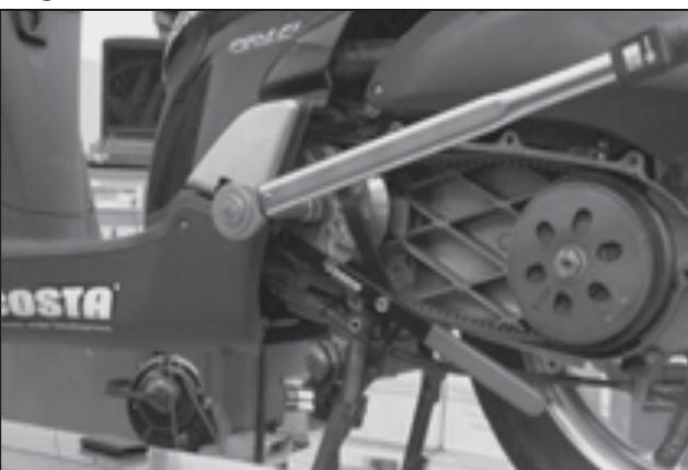
Apretar la tuerca con la llave **dinamométrica aguantando** la polea fija con el útil especial.
