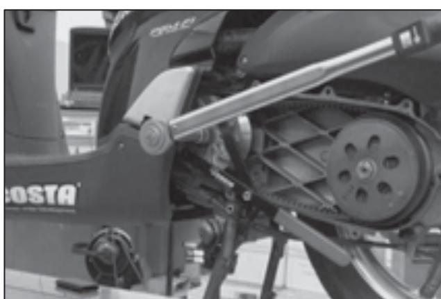
Serrer la femelle avec la clé dynamométrique en tenant la poulie fixe avec l'outil spécial.
