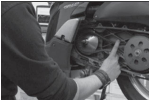
Avant de monter la poulie fixe, contrôler que la courroie soit détendue. Placer la poulie fixe et la femelle, en respectant toujours la position des possibles rondelles du variateur d'origine.
