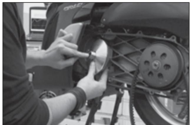
Colocar el variador sobre el cuello del cigüeñal. Respetar siempre la posición de las posibles arandelas que vengan con el variador original. J.COSTA recomienda sustituir la correa por una J.COSTA reforzada en el momento de hacer el cambio del variador.
