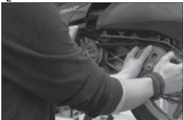
Una vez retirada la tapa procederemos a reducir la presión en la polea trasera para que la correa quede destensada.
