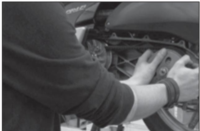
Une fois le couvercle retiré, procéder à réduire la pression sur la poulie arrière pour que la courroie reste détendue.
