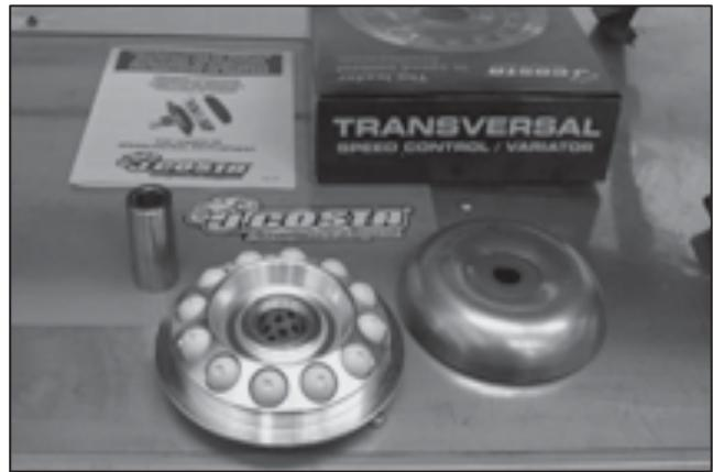
Comprobar que el kit esté completo, que no falte ninguna masa antes de realizar el montaje. Si el kit incorpora un bulón, éste debe sustituir al de origen, sino, se debe montar el original (comprobar que realmente sea el de origen y no de otro proveedor). Comprobar que el bulón tenga las mismas dimensiones que el original.
