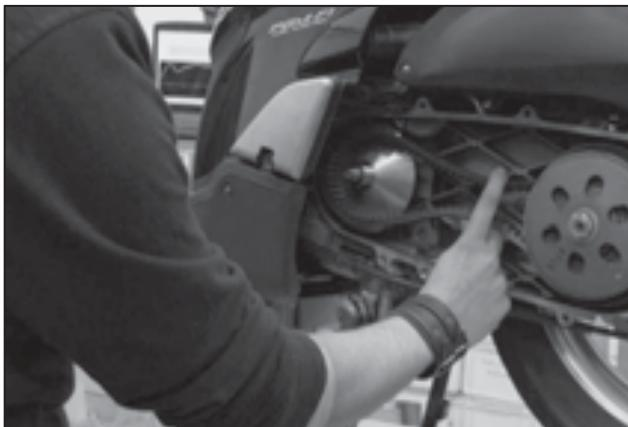
Antes de colocar la polea fija comprobar que la correa esté destensada. Colocar la polea fija y la tuerca, respetando siempre la posición de las posibles arandelas que vengan con el variador original.
