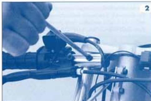
7- Smontare il coperchietto del comando gas. Controllare che il filo sia infilato correttamente nella sede della rotella avvolgilo e richiudere il coperchietto. Posizionare poi il comando del gas contro la leva del freno e serrarlo con le apposite viti M.5 TCEI in posizione di piena libertà di movimento della guaina del filo (vedi paragrafo 4.7).
