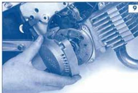
Mantenendo la fune in tensione (foto n.10), svitare la vite centrale; a questo punto far ruotare la puleggia lentamente fino a scaricare la molla.
