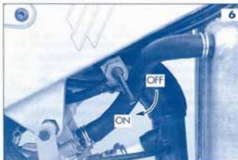
8- Aprire il rubinetto della benzina posto sotto il serbatoio sulla posizione "ON" (foto n.6).
