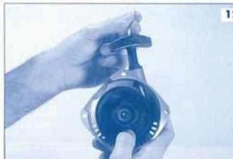
Avvitare ora la vite centrale utilizzando anche la rondella in dotazione, assicurandosi che la maniglia non penzoli, ma arrivi a fondo corsa, altrimenti ripetere l'operazione caricando maggiormente la molla.
