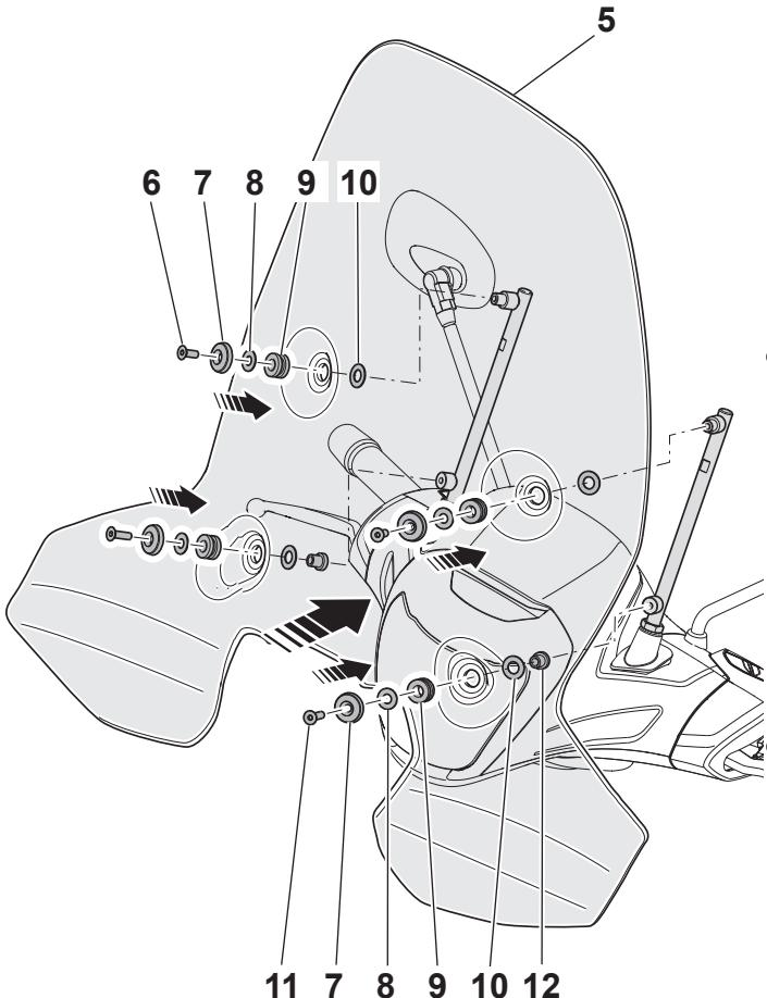
**I** Assemblare i passacavi cilindrici **9** nei fori presenti sul parabrezza **5**, poi montare il parabrezza sulle aste di supporto fissandolo come segue: nella parte superiore tramite le viti **6**, le borchie **7**, le rondelle piane **8** e **10**, nella parte inferiore tramite le viti **11**, le borchie **7**, le rondelle piane **8** e **10** e le boccole **12**.
