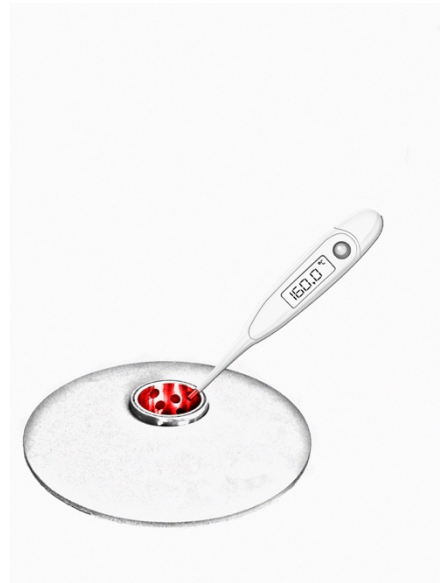
2. Vérifier la température du corps de variateur êtes autour de 160C°
